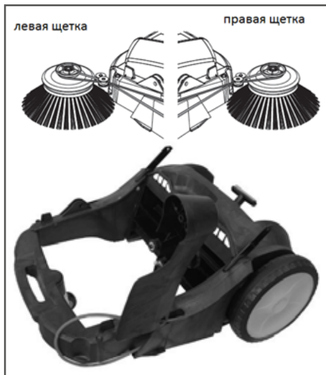
Рис. 14 Замена ремня привода круглой щетки
