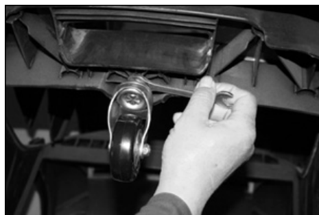
Рис. 16 Проверка затяжки крепления переднего колеса
